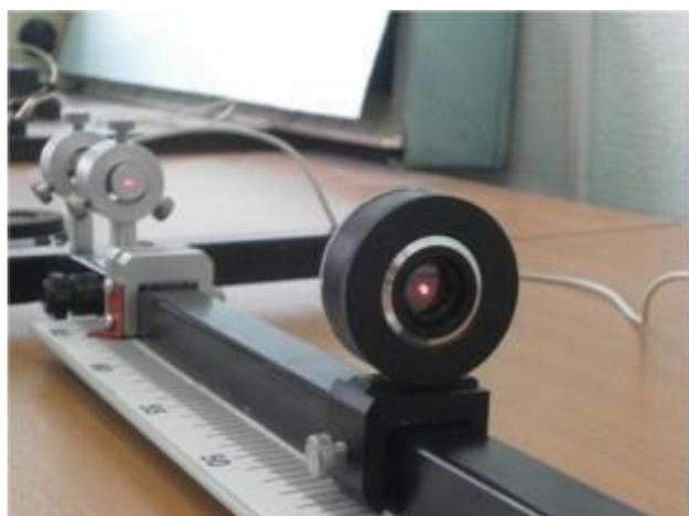
*Рис. 10.* Исследование степени поляризации источника лазерного излучения в лаборатории оптики
